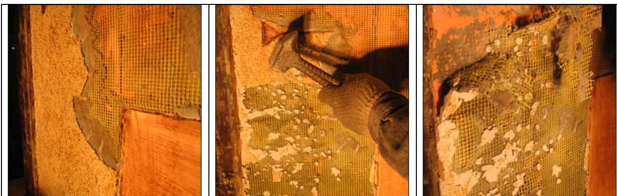
Процесс демонтажа фрагментов системы после 700 циклов воздействия. Состояние сетки на фрагменте с экструзионным пенополистиролом. Сетка частично отрывается при снятии, частично остается в базовом слое.
