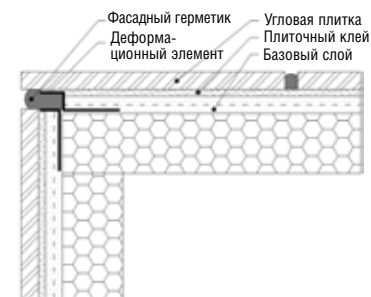
Рис. 11. Установка готового деформационного элемента (вариант 1).
